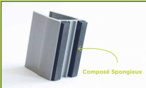
Notre moulure épouse parfaitement les sols afin de ne laisser passer aucune substance. Sa technologie lui confère une **flexibilité parfaite pour les sols inégal ou présentant des irrégularités**, avec un seuil de tolérance aux dénivelés positifs, négatifs et alternés jusqu'à 1/4" au pied.
